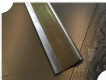
ตัดเหล็กความกว้าง ๕ เซนติเมตร ความยาวตามขนาดที่เหมาะสมกับเตา พับแผ่นเหล็กเป็นรูปตัว Z โดยพับรอยด้านบนและด้านล่างแผ่นเหล็ก เจาะรู ด้วยเครื่องปั๊มรูที่แผ่นเหล็ก
