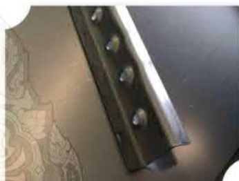
ตัดเหล็กความกว้าง ๕ เซนติเมตร ความยาวตามขนาดที่เหมาะสมกับเตา พับแผ่นเหล็กเป็นรูปตัว Z โดยพับรอยด้านบนและด้านล่างแผ่นเหล็ก เจาะรู ด้วยเครื่องปั๊มรูที่แผ่นเหล็ก
