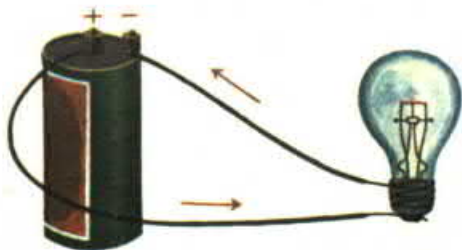
แสดงทิศทางกระแสไฟฟ้าไหลจากขั้วบวกไปยังขั้วลบ
