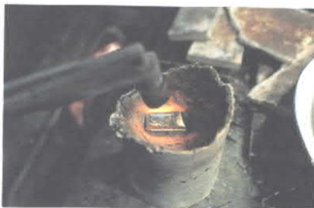
ทองคำบริสุทธิ์ถูกเผาด้วยความร้อน กลายเป็นของเหลว
