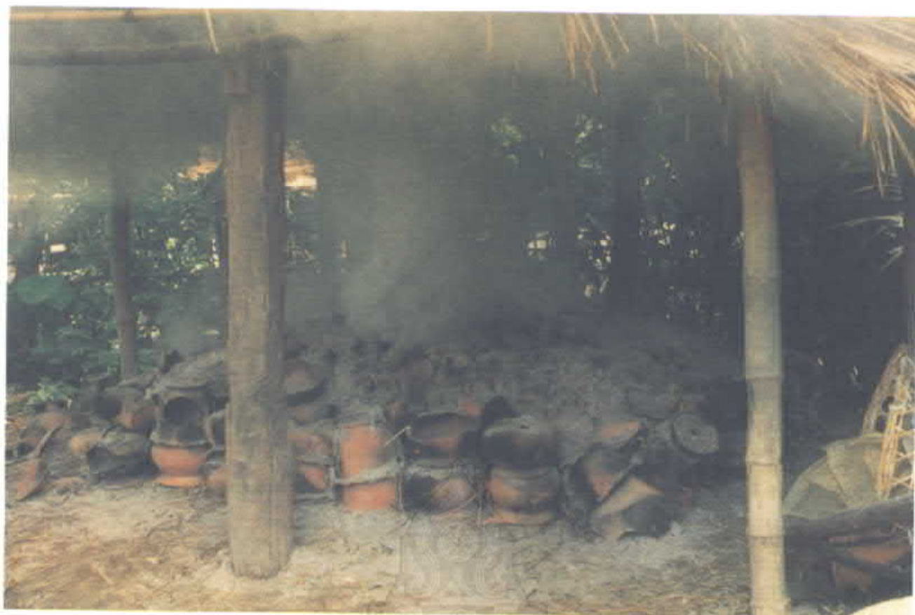
การเผาแบบเตาสุม เป็นแบบโบราณที่ยังมีใช้อยู่
