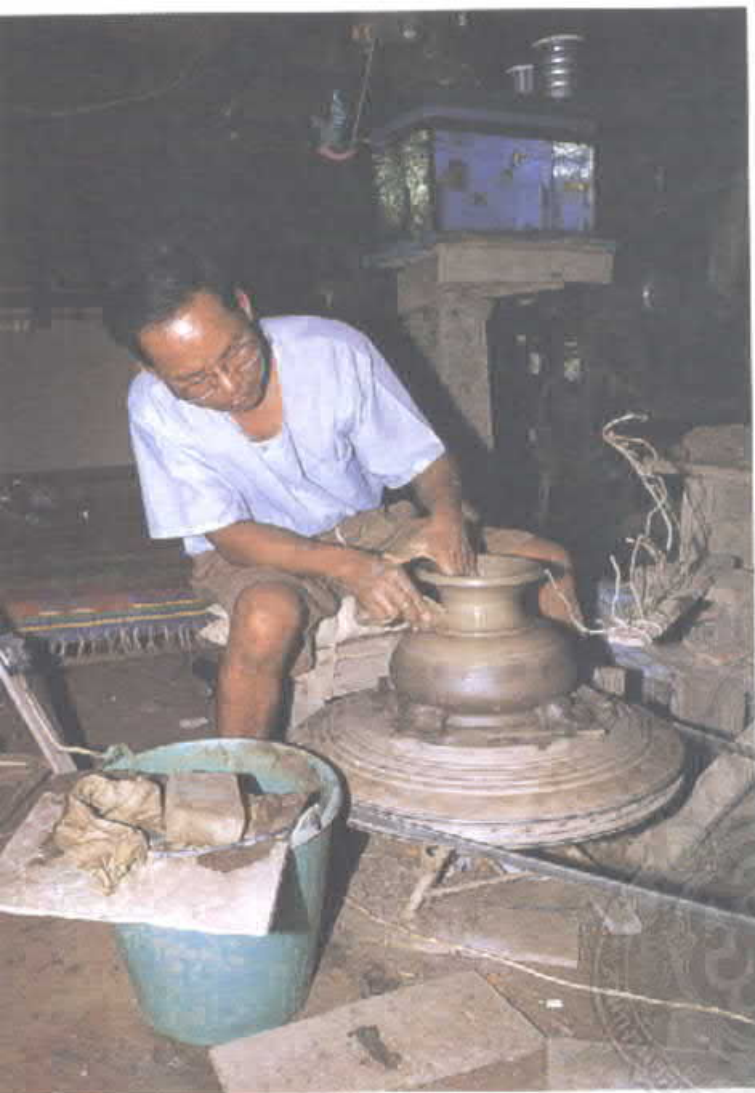
การปั้นที่ขึ้นรูปด้วยแป้นหมุน
