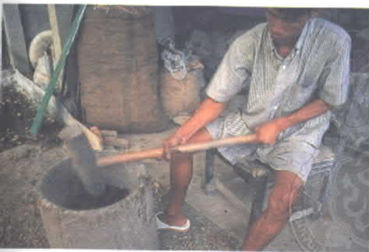
การทุบดินให้เป็นก้อนเล็กก้อนน้อย ก่อนนำไปหมัก
