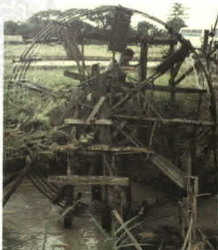
"พลูก" อุปกรณ์วิดน้ำเข้านาที่เสพัฒนามาเป็นเครื่องกลเติมอากาศกังหันน้ำชัยพัฒนา
