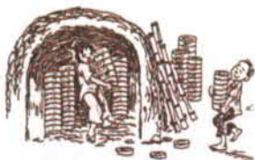
๓. นำถ้วยที่ชุบเคลือบแล้วบรรจุลงในเตาเผา (จิ๋ว)
