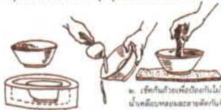
๓. นำถ้วยที่ชุบเคลือบแล้วบรรจุลงในเตาเผา (จิ๋ว)
