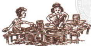
๑. ชุบเคลือบดินเผาด้วยการจุ่ม ชุบเคลือบดินเผาในขั้นตอนการตกแต่ง
