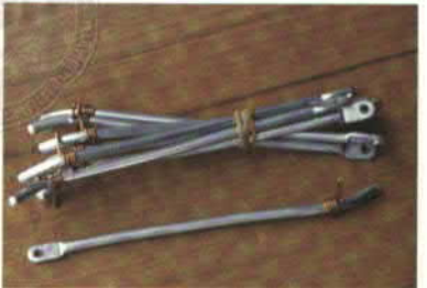
ลวดที่ตัด ตัด และเจาะรูเพื่อใช้ประกอบตัวรถ
