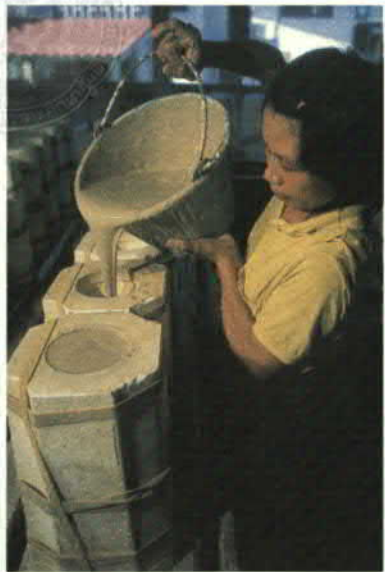
การเทน้ำดินลงในแบบพิมพ์
