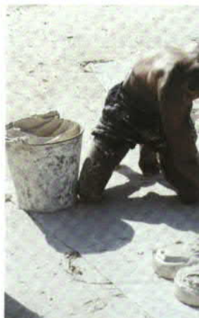
ดินขาวที่หยอดลงในวงแบบแล้วนำมาผึ่งแดด
