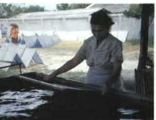
ใช้ตะแกรงซ้อนเยื่อสาขึ้นจากถังน้ำ
