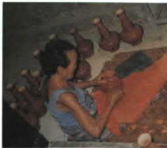
หลังจากลงสีแล้วขัดด้วยหินขัดให้เป็นมันเงา
