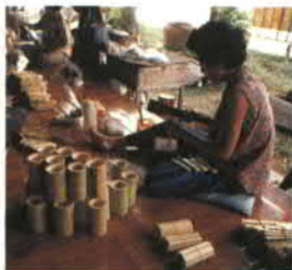
ผ่ากระบอกไม้ไผ่ที่ตัดเป็นท่อนแล้วมาผ่าสำหรับทำซี่ร่ม
