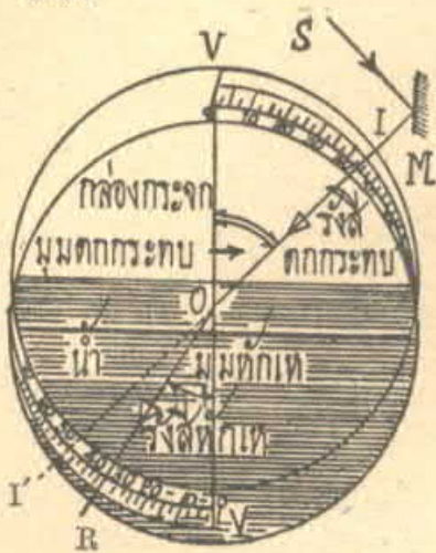
รูป 115 แสดงการหักเหของแสง เมื่อผ่านเข้าไปในน้ำ
