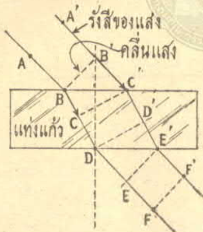
รูป 116 แสงหักเหเมื่อผ่านตัวกลาง ต่างชนิดกัน
