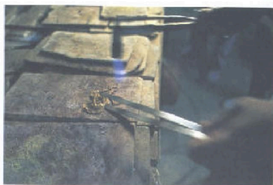
หลังจากแช่ในน้ำเค็มแล้วเอาทองมาเผาอีกครั้งหนึ่ง
