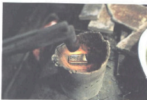
ทองคำบริสุทธิ์ถูกเผาด้วยความร้อน กลายเป็นทองเหลว
