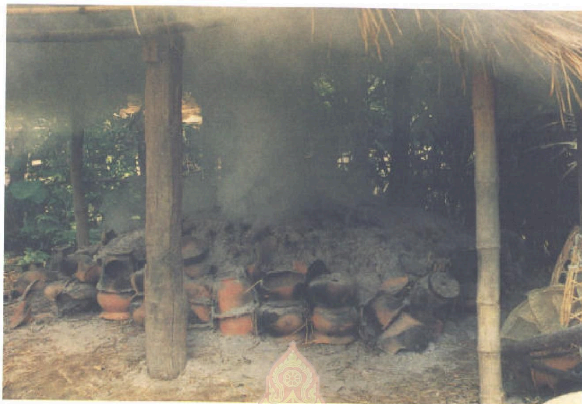
การเผาแบบเตาสุม เป็นแบบโบราณที่ยังมีใช้อยู่
